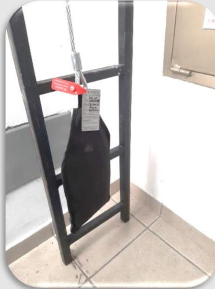
El kit cuenta con gancho de seguridad, absorbedor de choque en acero inoxidable, no requiere cambio en caso de ser impactado, tramo de cable y contra peso.
